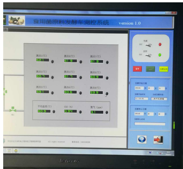
双孢菇栽培基质一次成型发酵车——控制系统界面
